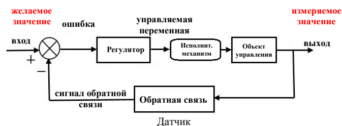
Рис. 1. Структурная схема замкнутой системы управления
