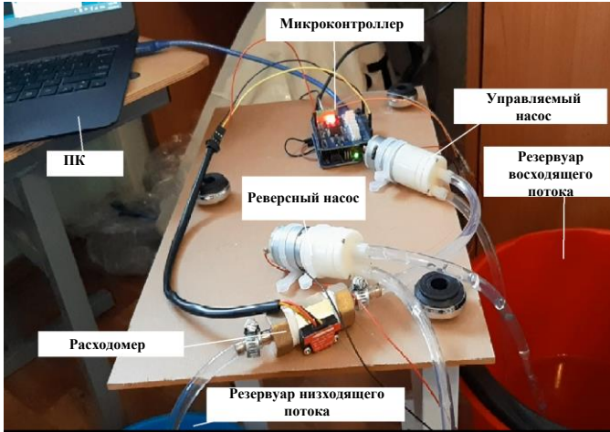
Рис. 3. Испытательный стенд для измерения скорости потока воды [13]
