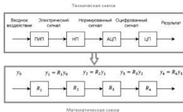
Рис. 2. Базовая модель измерительного канала
