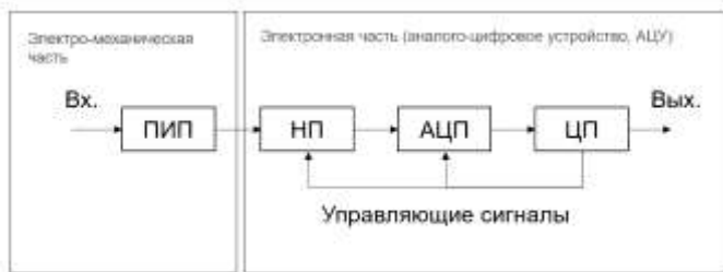
Рис. 1. Базовая структурная схема ИнСИ с электромеханическим датчиком
