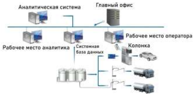
Рис. 2. Подключение станции к главному офису
