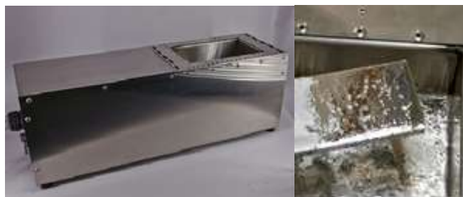
Рис. 1. Ультразвуковая ванна лужения и нанесение расплавленного припоя на алюминий (ООО «ИНЛАБ – Ультразвук»)
