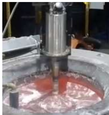
Рис. 3. Ультразвуковая обработка расплава металла (ООО «ИНЛАБ – Ультразвук»)
