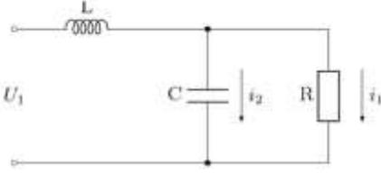
Рис. 2. Схема повышающего преобразователя при открытом ключе S
