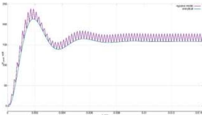
Рис. 4. Выходное напряжение  $V_{load}$  в модели ngspice
