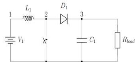
Рис. 1. Схема повышающего преобразователя постоянного напряжения
