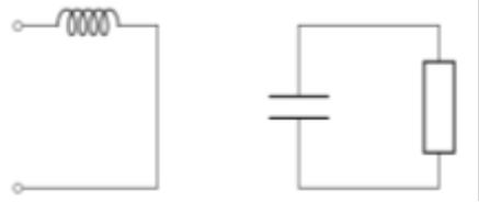
Рис. 3. Схема повышающего преобразователя при замкнутом ключе S
