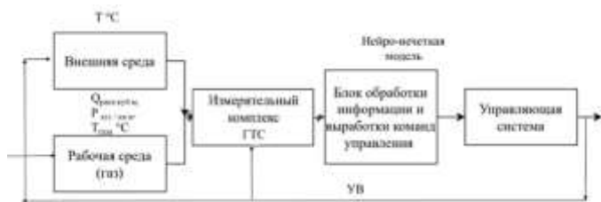
Рис. 1. Применение нейронечеткой модели для контроля параметров ТП учета расхода газа в ГТС
