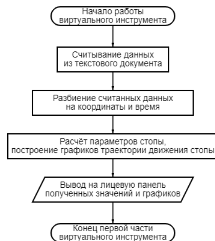
Рис. 2. Первая часть блок-схемы алгоритма виртуального инструмента
