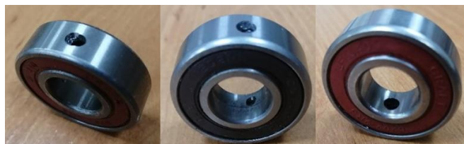
Рис. 3. Поврежденные подшипники для лабораторного стенда
