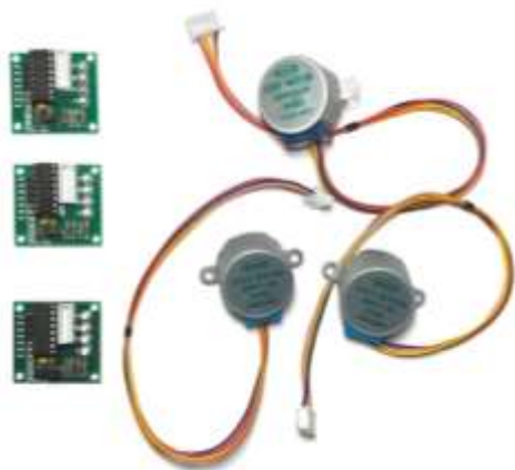
Рис. 2. Шаговые двигатели, используемые в модели
