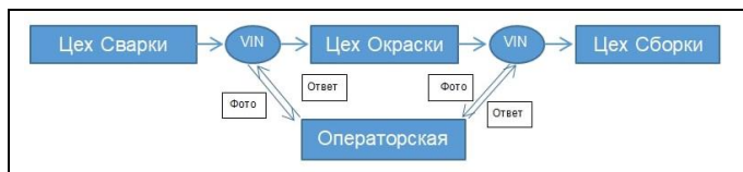
Рис. 1. Точки автоматизированного контроля VIN между цехами
