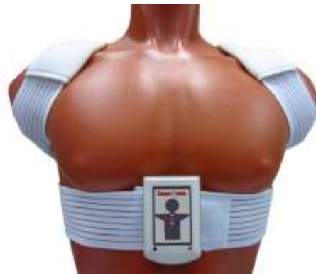
Рис. 6. Носимый кардиомонитор (патент автора)
