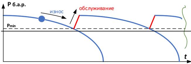
Рис. 3. Влияние износа и обслуживания оборудования на вероятность безотказной работы
