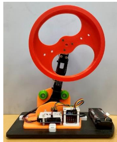
Рис. 5. Исследовательский стенд типа перевернутый маятник с инерционным колесом
