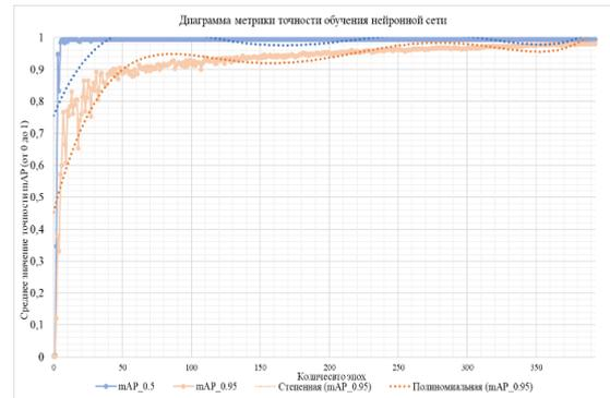
Рис. 7. График метрики точности mAP при обучении на искусственных данных, оранжевым метрика точности для вероятности объекта от 50% до 95%, синим – до 50%
