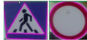
Рис. 1. Результат работы программы машинного зрения на примере опознавания дорожного знака «пешеходный переход» слева и знака «движение запрещено» справа
