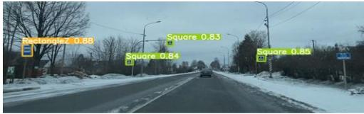
Рис. 5. Результат работы алгоритма распознавания знаков на тестовом изображении
