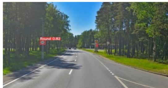
Рис. 2. Результат работы программы, использующей нейронную сеть для распознавания дорожных знаков
