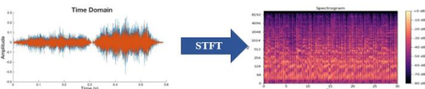
Рис. 3. Оконное преобразование Фурье звукового сигнала
