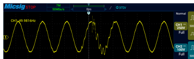
Рис. 3. Осциллограммы работы макетного образца инвертора 220 В 50 Гц при переключении в режим холостого хода
