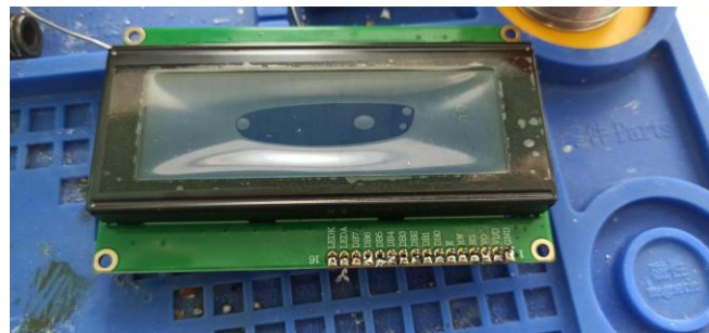
Рис. 4. Пайка LCD конвертора и Символьного дисплея
