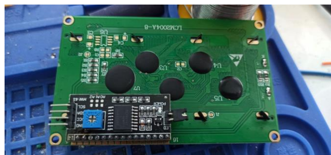
Рис. 5. Пайка LCD конвертора и Символьного дисплея
