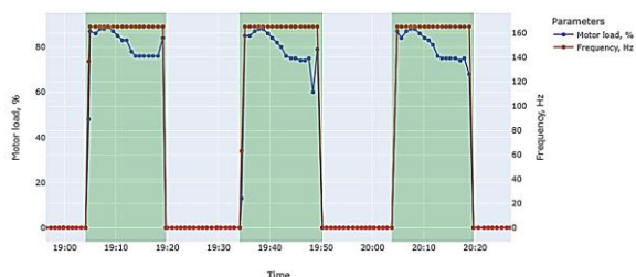
Рис. 4. Кластеры аномальной работы скважин по данным телеметрии загрузки двигателя
