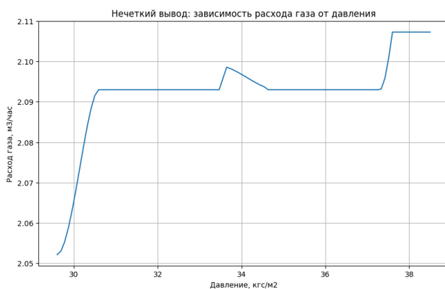
Рис. 3. График нечеткого вывода, зависимости расхода газа от давления на входе трубопровода
