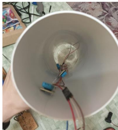
Рис. 3. Датчики помещены внутри трубы
