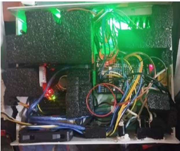
Рис. 6. Перенаправление воздушных потоков
