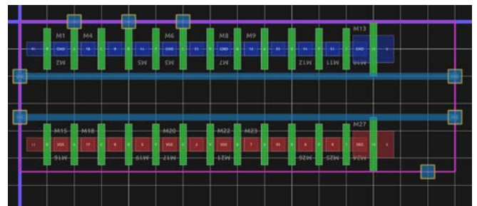
Рис. 4. Результат автоматического размещения транзисторов для схемы сумматора
