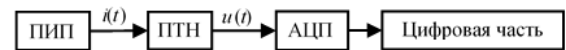
Рис. 12. Структура измерительного канала при выходном сигнале ПИП вида i(t) с использованием ПТН
