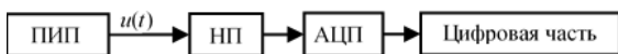
Рис. 6. Структура измерительного канала при выходном сигнале ПИП вида u(t) с использованием НП
