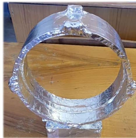
Рис. 5. Экранированный измерительный преобразователь магнитного поля
