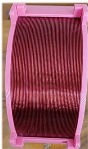
Рис. 3. Намотка катушки индукционного преобразователя
