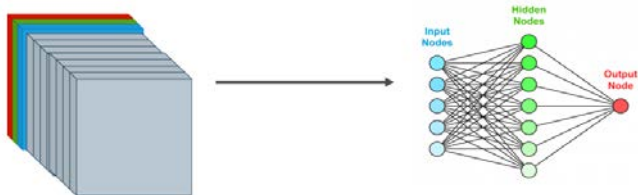
Рис. 1. Входные данные нейронной сети для случая с трехканальным (RGB) изображением и отдельными спектральными картами каждого индекса
