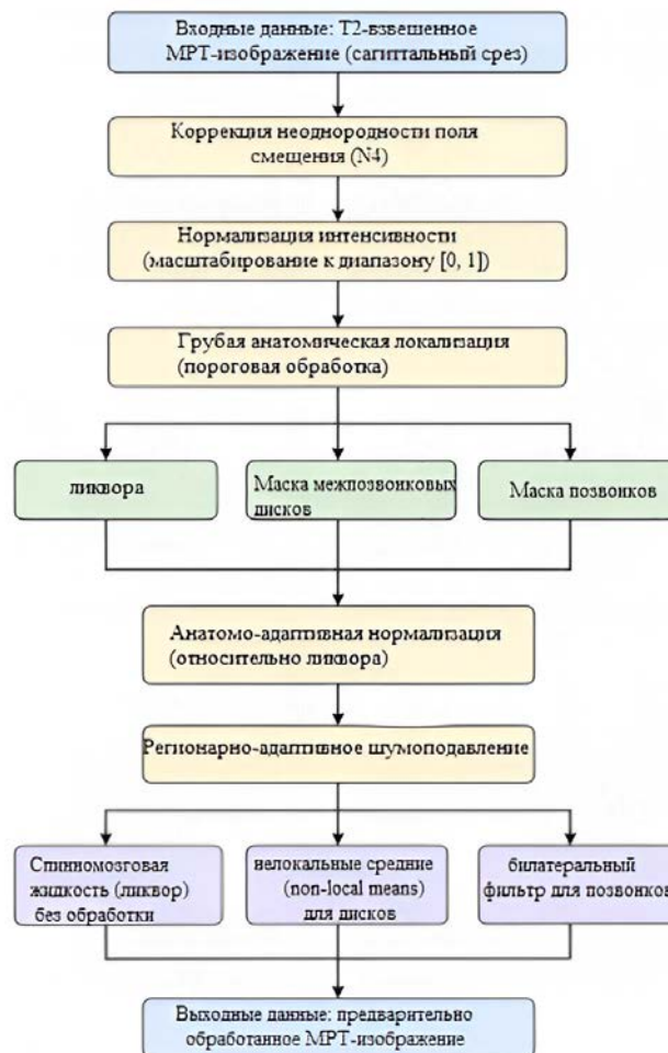
Рис. 1. Блок-схема анатомо-адаптивной предварительной обработки
